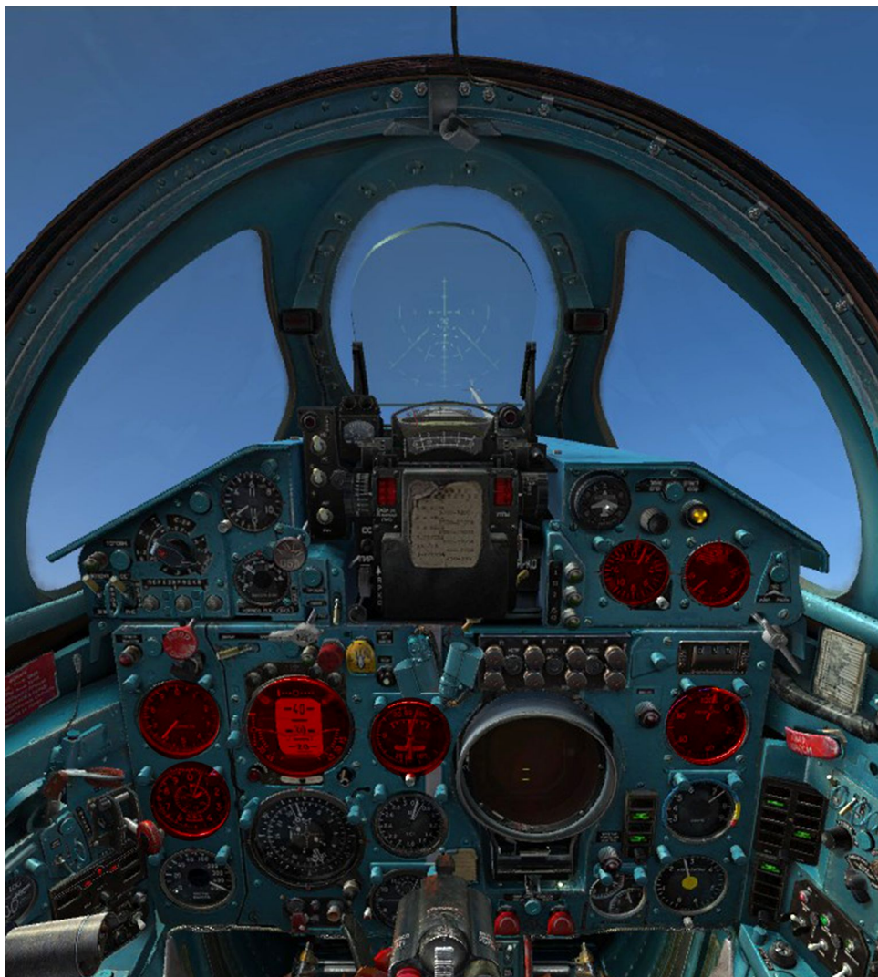
Изображение 8.1: приборы, на которые следует часто смотреть, окрашены красным. Однако старайтесь почаще оценивать и окружающую обстановку.
