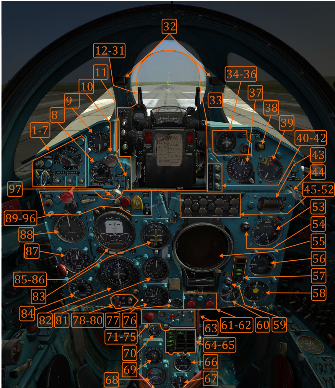
Изображение 6-3. Приборная доска. Нумерация сгруппированных выключателей ведется слева направо и сверху вниз. Печать этого изображения в высоком разрешении возможна по ссылке: ( Modsvaircraft\MiG-21BIS\Doc\Manual_images ).
