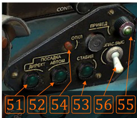
Панель системы автоматического управления САУ
