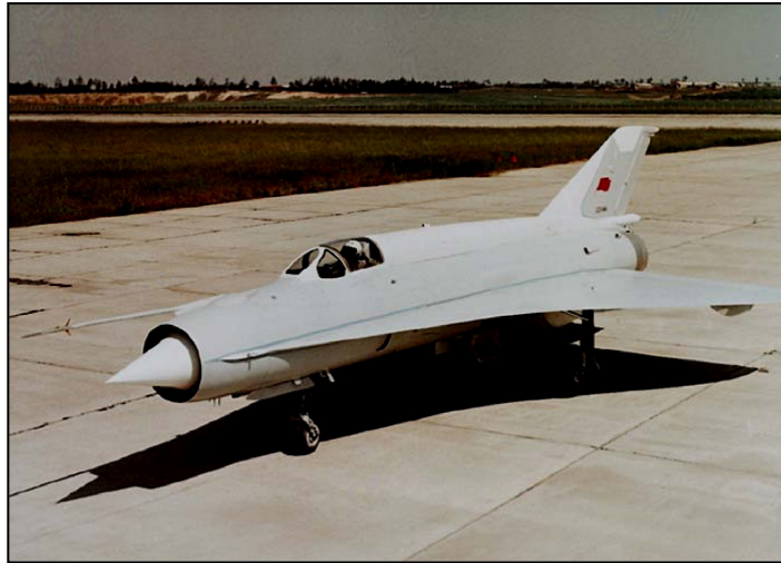
МиГ-21И “Аналог”, летающая лаборатория по отработке крыла сверхзвукового пассажирского лайнера Ту-144, 1961 год.
