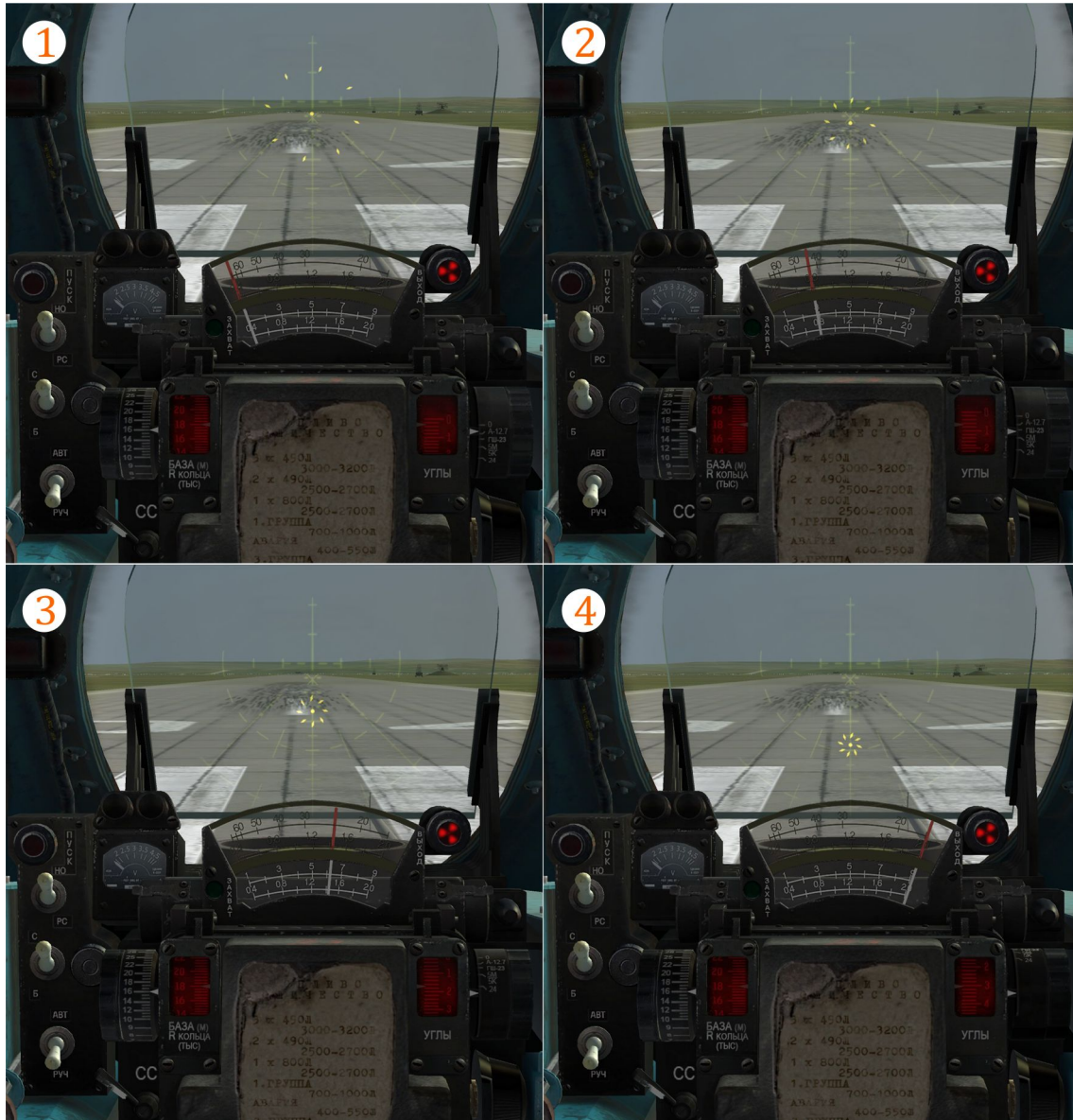
Изображение 10.5: Наглядная зависимость между дальностью (введенной поворотной рукояткой на РУД), размером прицельной марки и углом упреждения.
