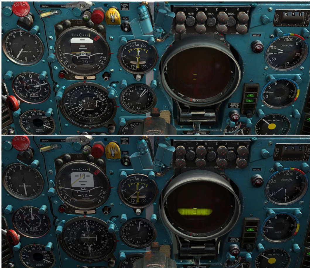
Изображение 9.12: Верхнее изображение показывает самолет на расстоянии 71км от станции РСБН в режиме «пробивания». Учтите, что глиссада находится ниже самолета (директор высоты), тогда как вертикальная скорость находится в пределах рекомендованной (желтая горизонтальная планка на КПП). На нижнем изображении тот же самолет на расстоянии 24км от станции РСБН, в глиссаде и со скоростью снижения выше рекомендованной.
