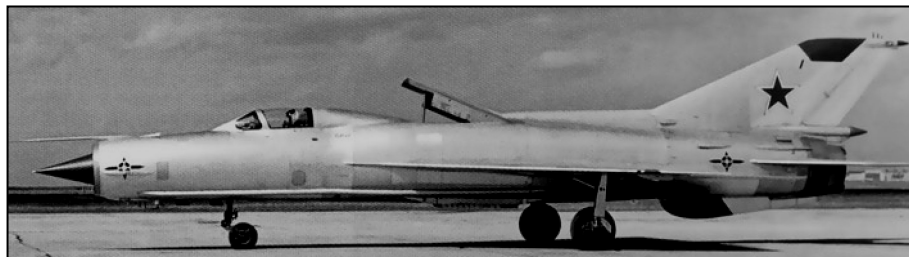
МиГ-21ПД, летающая лаборатория с укороченным взлётом/посадкой для отработки подъёмных двигателей самолёта МиГ-23ПД, 1966 год.
