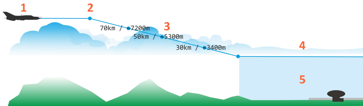
Изображение 9.9: Директорная траектория снижения в режиме пробивания:
