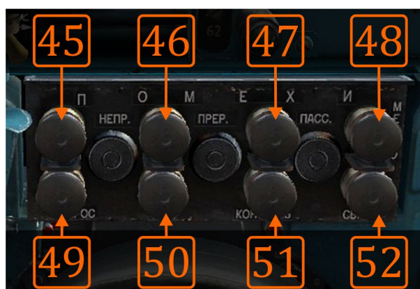
Изображение 10.8: Применяемые на «Сапфире» средства компенсации преднамеренных и естественных помех.
